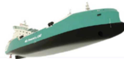
Capacidad 10.000 m 3 Eslera Total 119,35 m Manga 20,5 m Sistema de generación gas/diesel-eléctrico Diseño Ghenova Ingeniería
